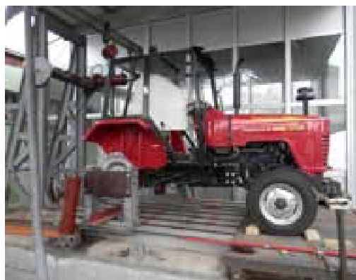
Slika 6. Probni sto za ispitivanje kabine Fig. 6. Test table for cabin testing
